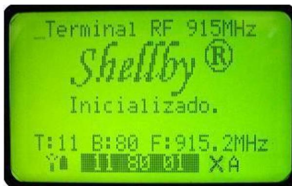
**Figura 3:** Exemplo de Terminal sem comunicação, repare na falta do ícone nº 1 e a presença de um X no ícone 7.
